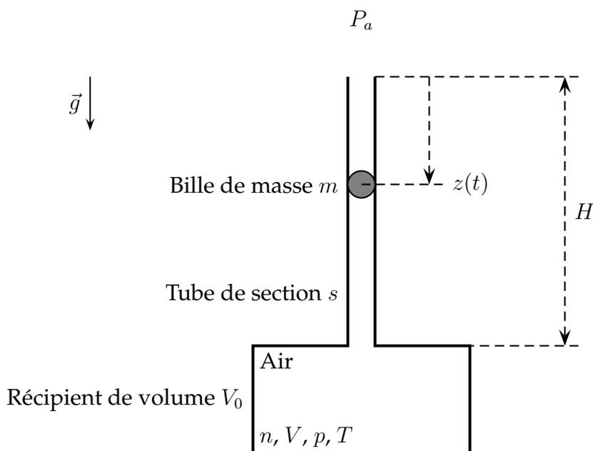
FIGURE 1 – Principe de l'expérience de Rüchardt.
