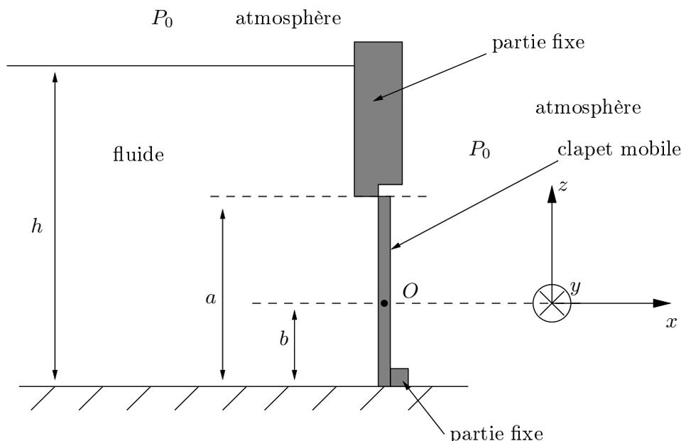
On considère un clapet de sécurité rectangulaire de largeur  $l$  (dans la direction  $\vec{u}_y$ ) et de hauteur  $a$  articulé autour d'un axe fixe horizontal  $\Delta = (O, \vec{u}_y)$  où  $O$  est un point situé à une hauteur  $b$  du fond. Le niveau du liquide, de masse volumique  $\rho$ , au dessus du fond du bassin est noté  $h$ . La pression atmosphérique de l'air, noté  $P_0$ , est supposé homogène.
