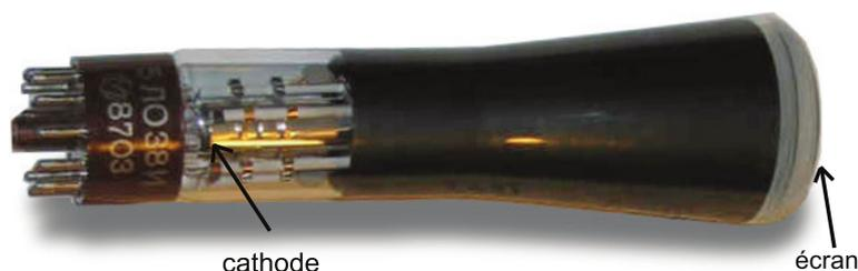
FIGURE 1 – Petit tube d'oscilloscope, de longueur d'environ 20 cm.
