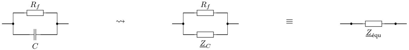
Ici, on a associé le résistor  $R_f$  et le condensateur  $C$  en parallèle d'où
