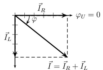
On mesure ensuite (échelle :  $1 \text{ V} \leftrightarrow 1 \text{ cm}$ )  $I \simeq 7,0 \text{ A}$  et  $\varphi = -38,5^\circ$ .
