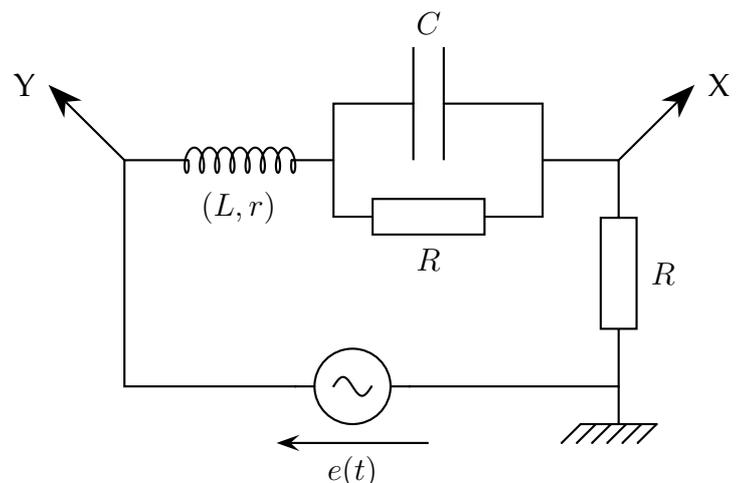
On remarque que sur la voie X, on mesure « l'intensité » (tension aux bornes d'un résistor). Puisque X et Y sont en phase, c'est donc que Y n'est pas déphasé par rapport à l'intensité. On en déduit que l'impédance équivalente entre Y et la masse est un réel.
