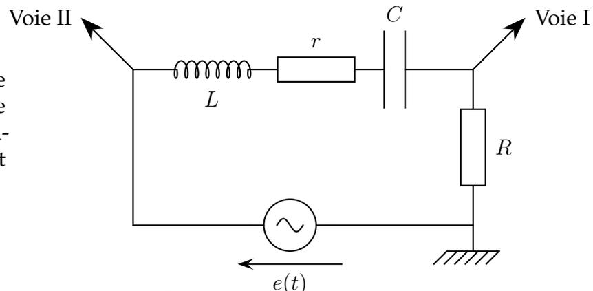
1. En notant  $u(t)$  la tension de la voie 1, exprimer  $\underline{u}$  en fonction de  $\underline{e}$ ,  $r$ ,  $R$ ,  $L$ ,  $C$  et  $\omega$ .
