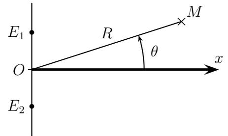
On déplace le microphone sur un grand cercle de rayon  $R = 0,5\text{ m}$  et on relève l'évolution de l'amplitude mesurée en fonction de l'angle  $\theta$  que fait la direction  $\overrightarrow{OM}$  avec l'axe  $x$ .
