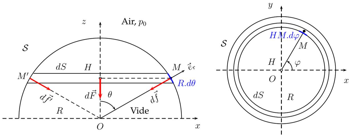
Par définition de la pression  $p_0$ , on a  $d\vec{f} = p_0 \cdot ds \cdot \vec{u}$  où  $\vec{u}$  est le vecteur unitaire normal à la surface élémentaire  $ds$  et orienté du fluide vers la paroi.
