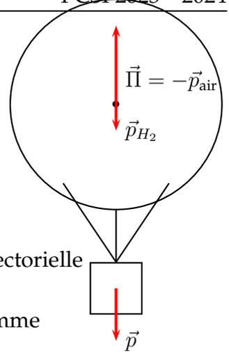
La résultante des forces exercées sur le ballon est donc la somme vectorielle  $\vec{F} = \vec{p} + \vec{p}_{H_2} + \vec{\Pi} = -mg\vec{e}_z - m_{H_2}g\vec{e}_z + m_{air}g\vec{e}_z$
