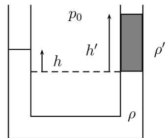
En versant un volume  $V' = 3 \text{ mL} = 3 \text{ cm}^3$  de liquide de masse volumique  $\rho'$  dans le tube de section  $s = 1 \text{ cm}^2$ , on a formé une colonne de hauteur  $h' = \frac{V'}{s} = 3 \text{ cm}$ .
