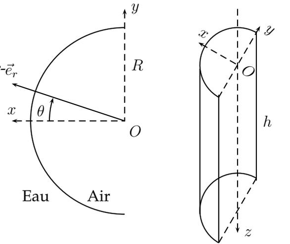
1. La forme du barrage est choisie de façon à ce que la résultante des forces de pression exercées par l'eau ait tendance à comprimer le mur de béton, il est alors plus résistant que si on l'étirait.
