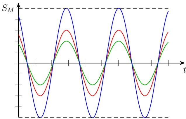
FIGURE 2 – Signaux en phase :  $\Delta\varphi = 0$
