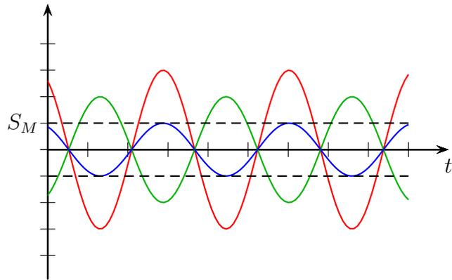
FIGURE 3 – Signaux en opposition de phase :  $\Delta\varphi = \pi$
